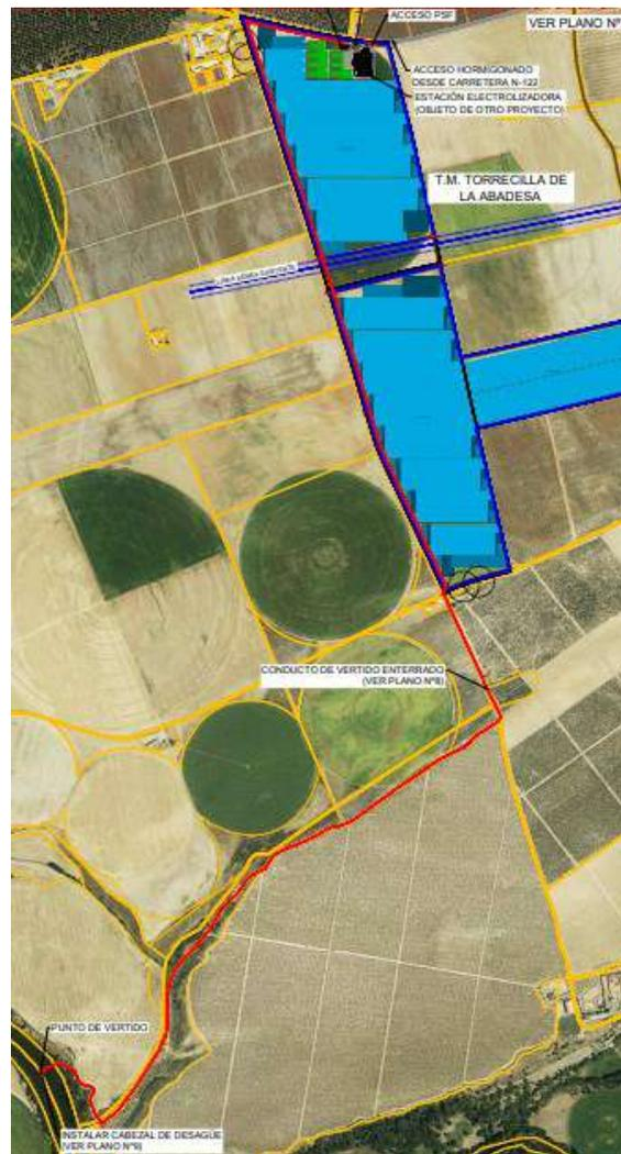
*Ilustración 3: Canalización desde punto de origen hasta punto de vertido*
