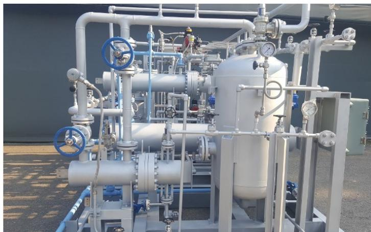
*Ilustración 10. Sistema DE-OXO para purificación de hidrógeno.*
